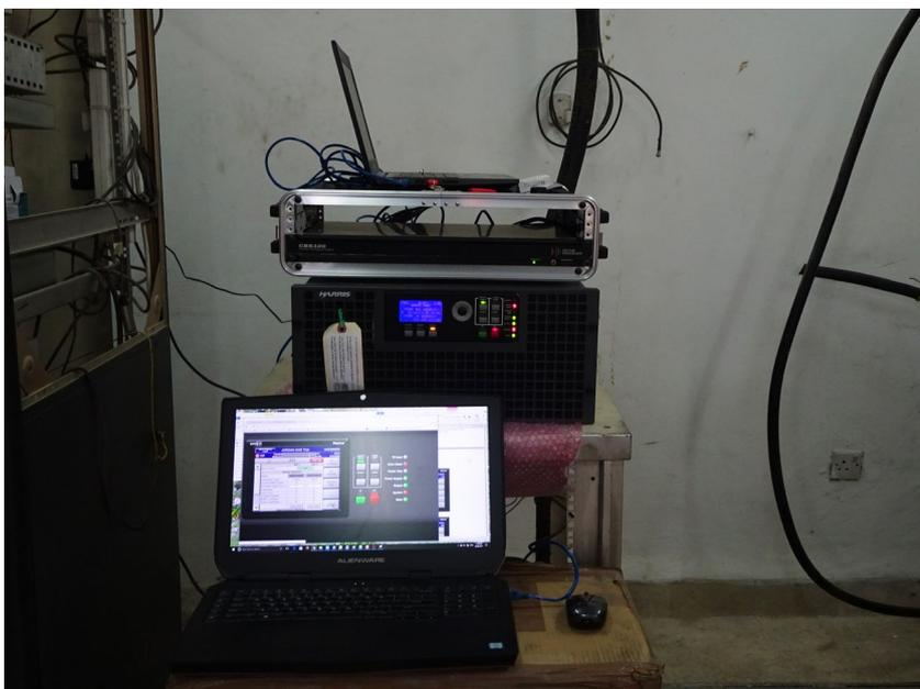
Figure 5-1 : Exemple de système de démonstration DAB+ à faible puissance
